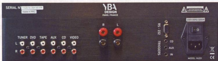
La face arrière du modèle de série sera équipée, comme spécifié dans le texte, de sorties préampli et d'une boucle de monitoring. La connectique dorée 24 k.
