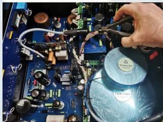
La construction du coffret de l'appareil, est réalisée en tôle d'acier rigide avec une façade avant en de 4mm en aluminium noir ou blanc. Les boutons peuvent être noir ou argent selon votre choix. Une attention particulière est apportée à la qualité des câbles, en cuivre OFC et OCC de qualité audiophile, ainsi que leur tressage.
