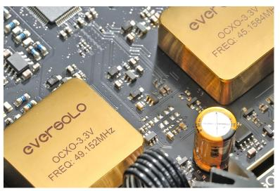
La technologie de contrôle de température développée sur mesure par Eversolo pour le système d'horloge OCXO garantit que les deux oscillateurs à cristal audio (45,1584 MHz et 49,152 MHz) fonctionnent à un point de température optimal constant, éliminant ainsi les fluctuations de fréquence causées par les changements de température, offrant un bruit de phase extrêmement faible. Chaque
