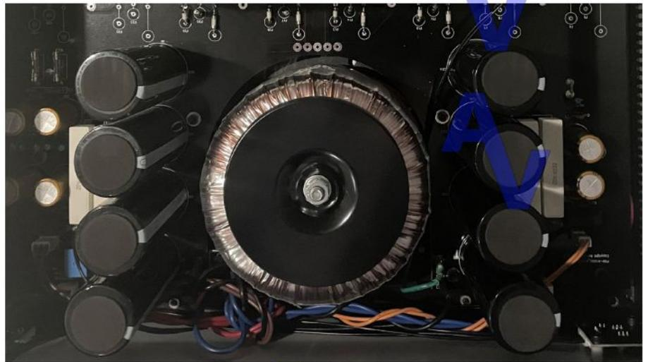
Cette combinaison d'un transformateur toroïdal et d'une grande capacité de stockage signifie que vous disposez d'une puissance utilisable plusieurs fois supérieure à la puissance nominale continue et que cela signifie une écoute dynamique et sans distorsion.
