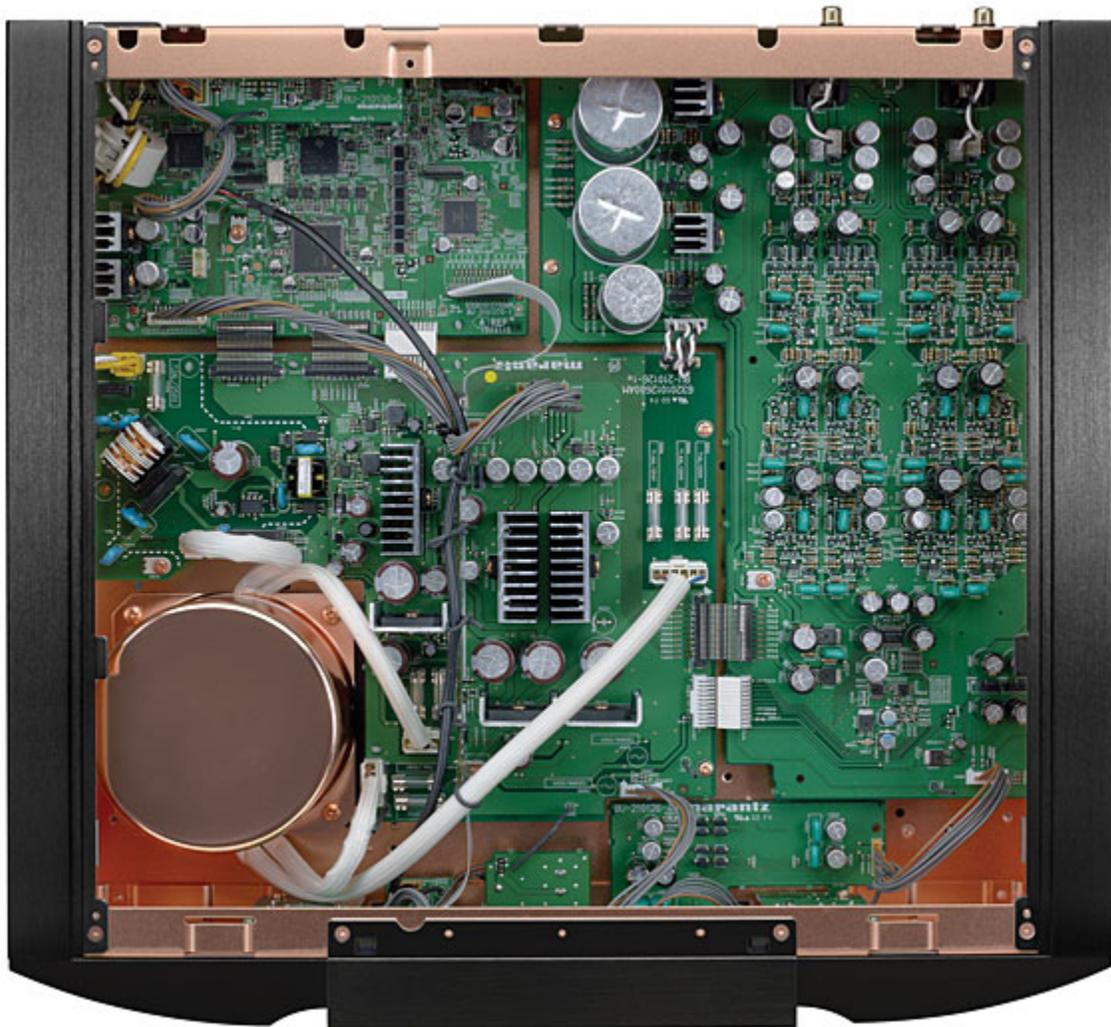
À l'intérieur du vigoureux châssis du NA-11S1, le circuit numérique est basé sur un DAC de capacité DSD, les circuits analogiques de haute vitesse HDAM-SA2 de Marantz et modules HDAM. Les composants passifs tels que les condensateurs de qualité audiophile avec dessus en argent de Nichicon, ont été choisis après de nombreux tests d'écoute. Lors de notre conversation Skype, je demandai Ishiwata ce qui avait été ses critères dans le choix des composants.
