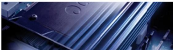
Notre système de refroidissement quasi silencieux canalise la chaleur à travers un dissipateur thermique et un ventilateur thermostaté, ce qui signifie que nos systèmes restent au frais sans livrer ni bruits ni parasites. Seulement dans des moments de consommation d'énergie de pointe et que le ventilateur sera vraiment être à pleine vitesse (et ces moments, bien sûr, vous serez capable de l'entendre).
