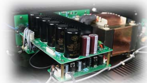
Alimentation avec Condensateurs & Transformateur
