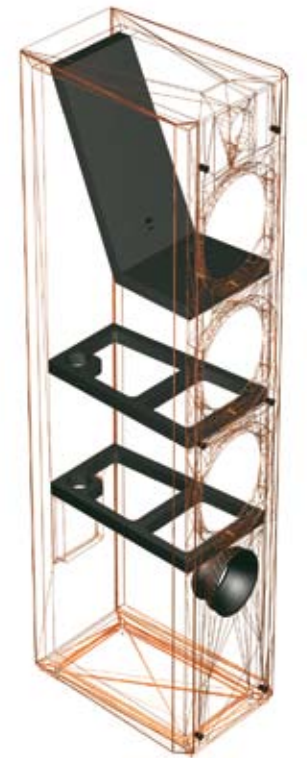
> Le souci permanent du détail est une démarche typiquement haut de gamme : construction en MDF jusqu'à 25 mm d'épaisseur, renforts internes multiples intégrant le passage des câbles, structure non parallèle des parois, chaque détail est parfaitement intégré à la conception. Des prestations uniques dans cette gamme de prix.
